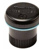
PCN-25 Portata: 0,06 m 3 /ora; 0,9 l/min
